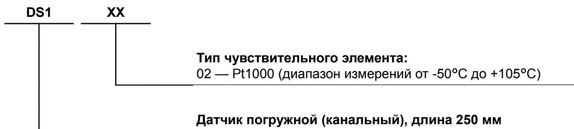
**Пример записи обозначения датчика для заказа: DS1-02**
